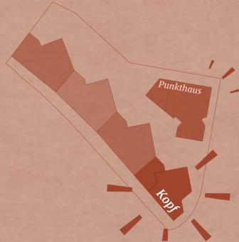
Der angemessene Umgang mit den unterschiedlichen Situationen Straße / Hof wird durch die **Reihung einer einzigen Haustypologie** erzeugt. Der Kopfbau ist dabei nur leicht abgewandelt, um auf die besondere Situation der Kreuzung und des Eingangs zum Innenhof zu reagieren. **Auch das Punkthaus im Nordosten kommt aus der gleichen Familie.**
