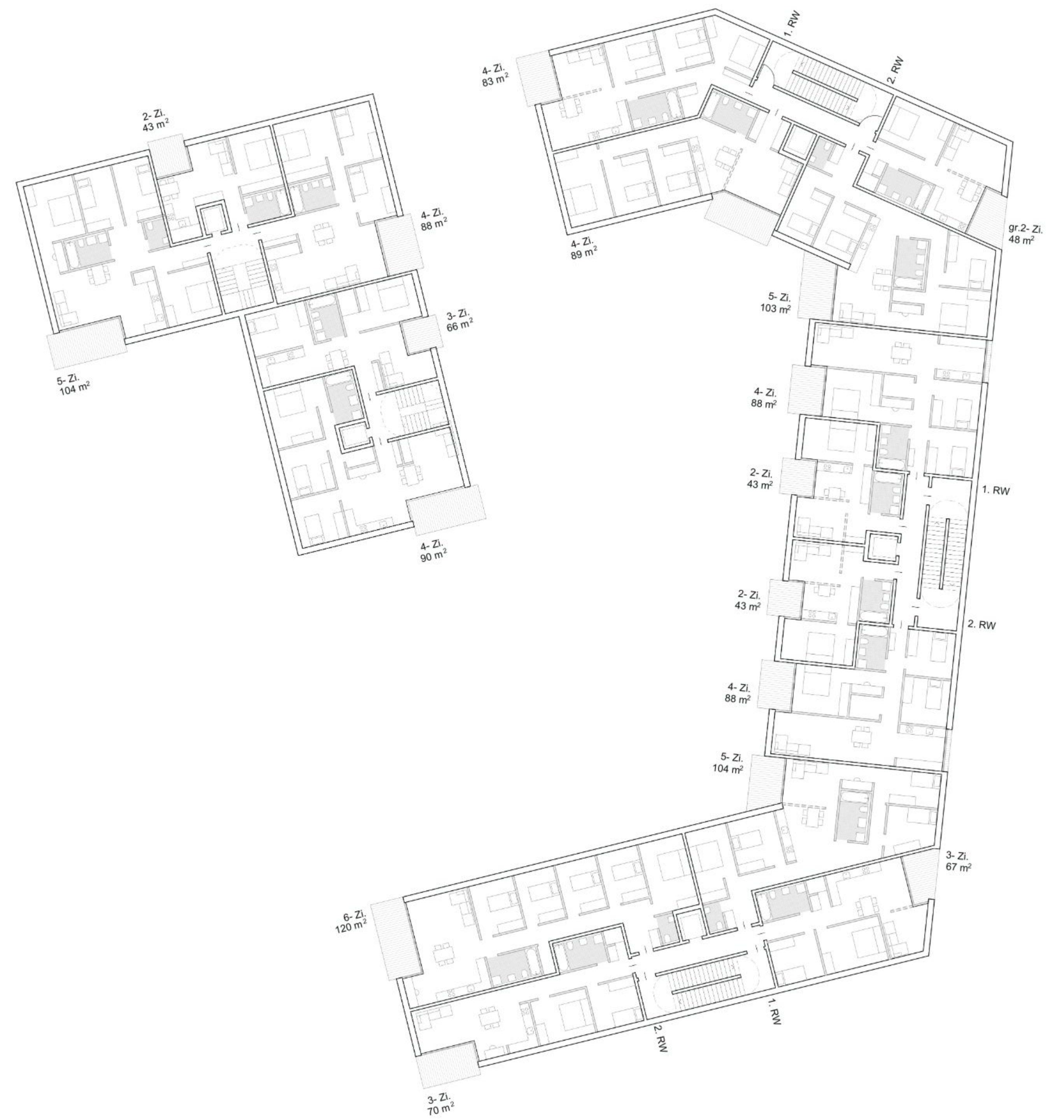
Grundriss 1.OG / 2.OG Baufeld C6 1 | 200
